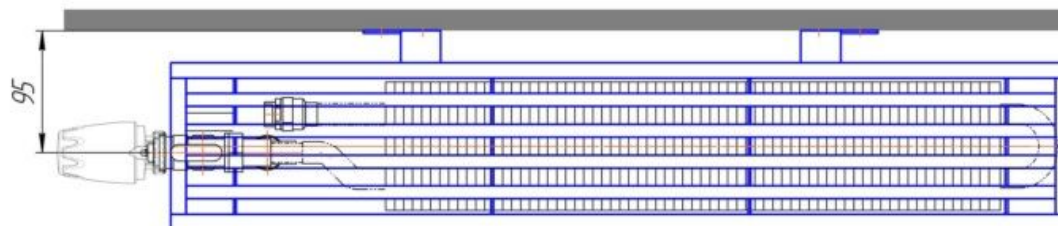
монтаж с левосторонним подключением
